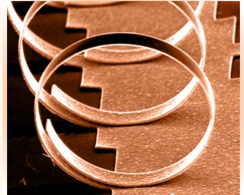
Released Cantilevers after Thermal Annealing Nicolas André Université Catholique de Louvain, Belgium
